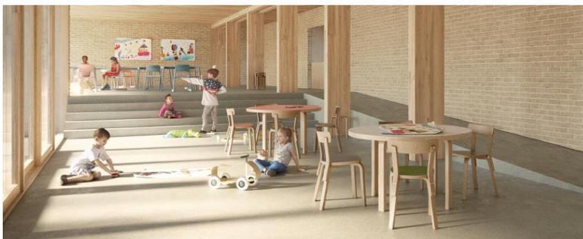
Le bois est thermiquement meilleur que le béton. Avec l'utilisation de briques d'argiles crues et les parois en bois d'épicéa à l'intérieur des classes, la matérialité agit comme un régulateur d'humidité et de chaleur et s'inscrit dans le modèle écologique et recyclable de Minergie P Eco. Ces matériaux naturels ne nécessiteront pas, contrairement aux revêtements de surfaces appliqués usuellement, de maintenance ou d'entretien lors de l'exploitation des bâtiments.
