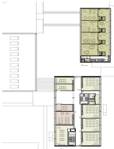
Le choix d'une structure en bois permet la mise en place d'une trame régulière simple. Elle induit une mise en œuvre rapide. La logique du système constructif permet aisément de réaliser une extension future
