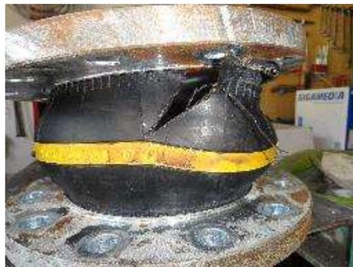
La compensation en caoutchouc de la pompe pour pousser les boues vers le silo de stockage des boues a lâché. Les boues se sont ainsi retrouvées dans le local de la centrifugation. Cette compensation a été modifiée par une pièce en inox.
